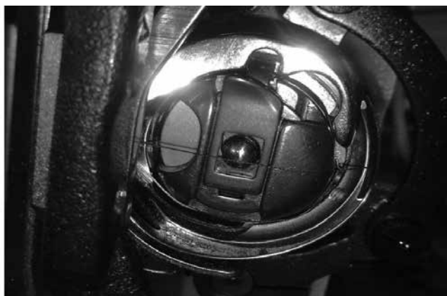
شکل ۲۱ - نخ دوخت در حالت ساعت شش
