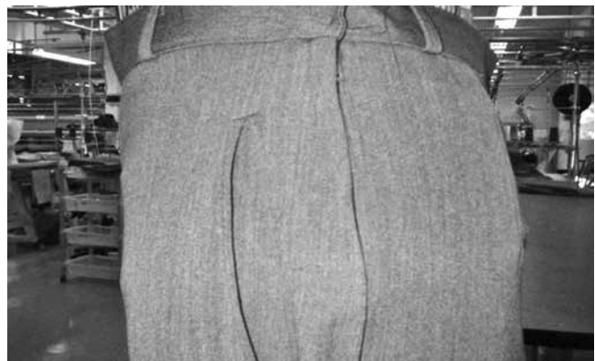
شکل ۱۷- چروک سازی دنده کار پیشبر زیپ پس از فشار روی کار
