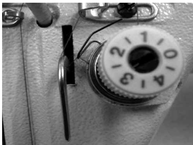
شکل ۲۲ - فنر کنترل سفتی نخ برای کاستن از کشش آن
