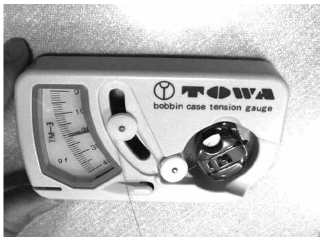
شکل ۱۱- دستگاه سنجش میزان کشش نخ ماسوره
