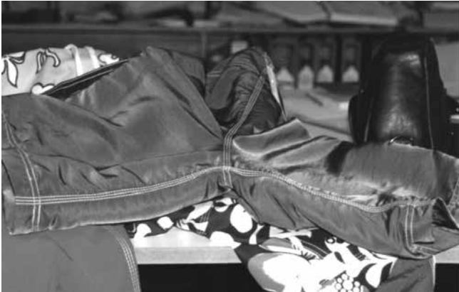
شکل ۲۸- مثالی از چروک بخیه در شلوارهای دریایی
