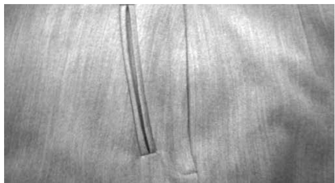
تصویر ۱۸- با تنظیم کشویی کار پیشبر چروک سازی دنده کم شده است
