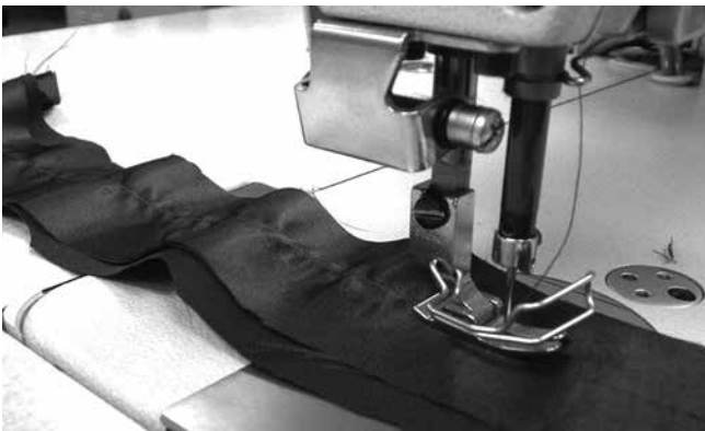
شکل ۲۹- مثالی از چروک بخیه ناشی از کشش نخ
