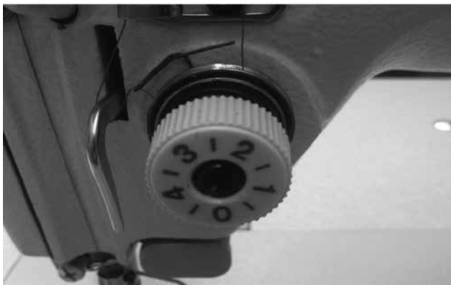
شکل ۲۰- چک تنظیم فنر سفت کن نخ بین ده و ربع به ساعت
