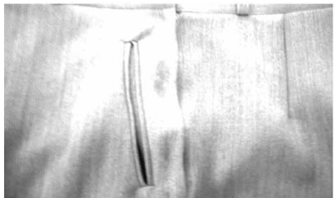
شکل ۱۶- چروک سازی دنده کار پیشبر در زیپ قبل از تنظیم کشویی کار پیشبر
